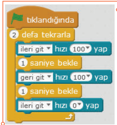
Resim 6.54: Robot hareketi için DC motor kullanımı örneği
