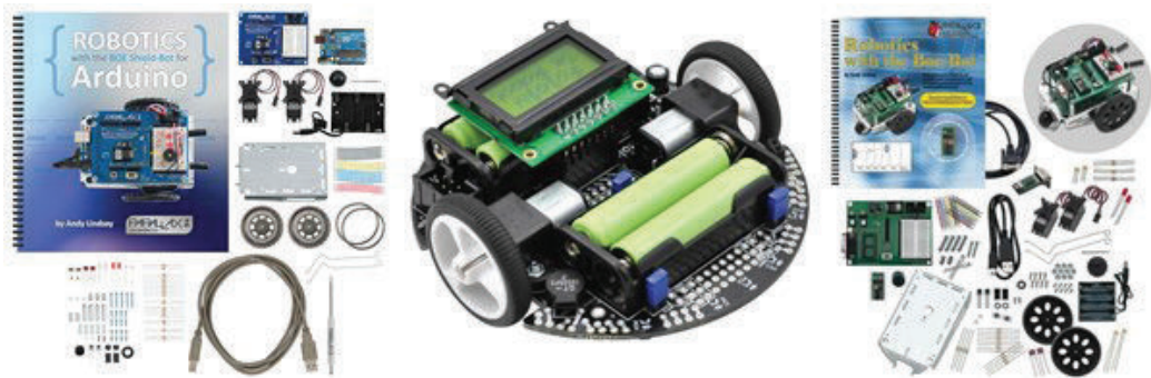
Resim 2.27: Düşük maliyetli minimum özelliklerde mobil robot tasarım kitleri
