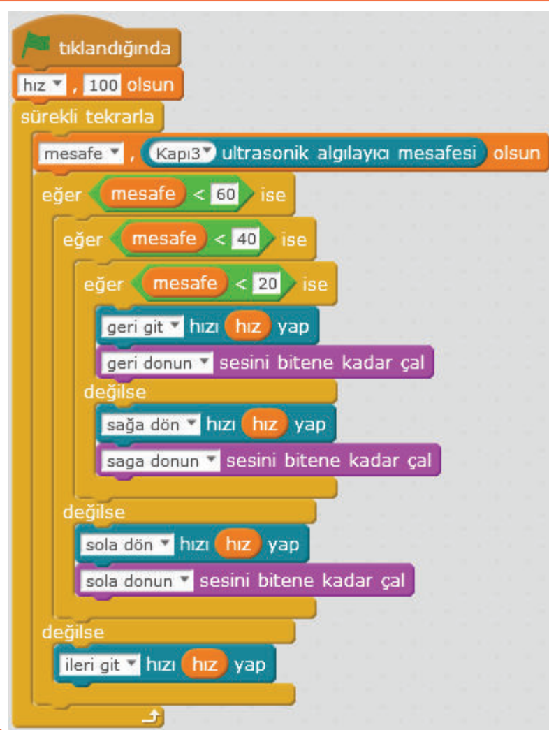
Resim 6.61: Ultrasonik algılayıcı kullanarak engele çarpmadan dolaşma uygulaması
