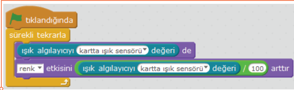
Resim 6.63: Işık algılayıcı kullanarak renk değiştirme örneği
